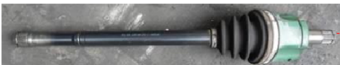
5.3：将轴杆表面的油脂清理干净
