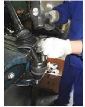
4.4: 敲击以拆卸球笼 (在拆卸过程中注 意确保安全)
