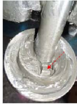
4.3: 注意：拆卸外球笼 时将敲击力作用 尖头指定的位置。
